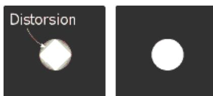
Certaines jumelles disponibles sur le marché ont une pupille de sortie imparfaitement circulaire à cause du matériau du prisme de mauvaise qualité. Cela produit une pupille de sortie avec les bords ombragés, se traduisant par une luminosité réduite de l'image. Il va sans dire que les pupilles de sortie des jumelles de bonnes qualités sont toutes parfaitement circulaires et nettes.
